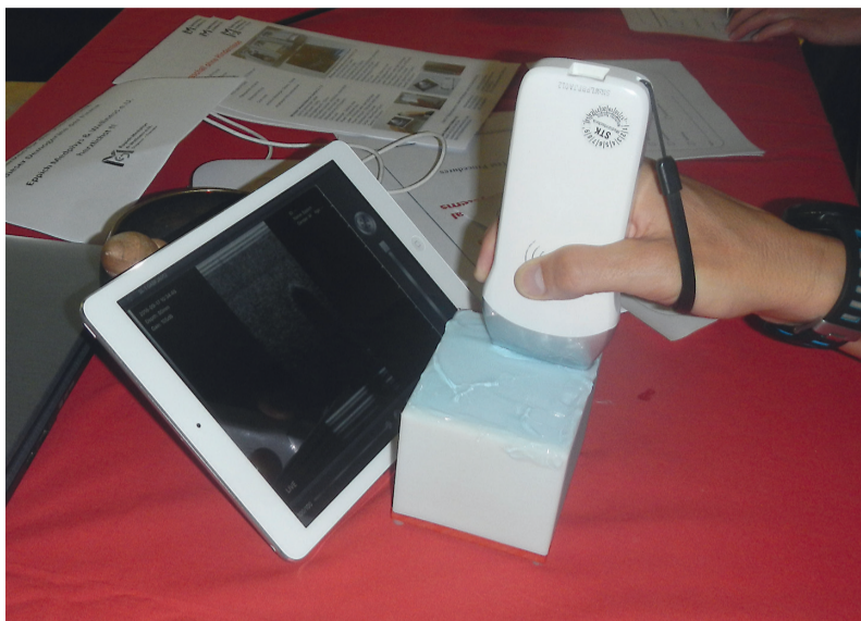
Demonstration einer kabellosen Sonde (LA) im Einsatz bei einem Praktikum zur Erkennung von häufigen Artefakten mittels Phantom. Die Realtime-Ultraschallbilder (B-Mode) der Sonde werden per WLAN-Anbindung an ein Tablet (IPAD/Android) übertragen.
